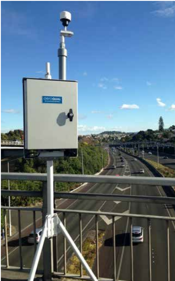
Dust Sentry može meriti i buku, vetar i vremenske uslove sa opcionim senzorima
