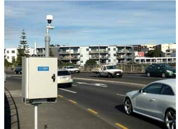
Dust Sentry je odličan način za monitoring ili izvođenje istraživanja o česticama kraj puteva
