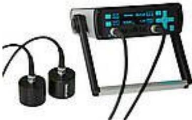
**Pundit Lab** je ultrazvučni test instrument koji se koristi za ispitivanje kvaliteta betona. Ultrazvučna test oprema Pundit Lab ima online akviziciju podataka, analizu talasnih oblika i potpunu daljinsku kontrolu transmisije parametara. Zajedno sa tradicionalnim merenjem tranzitnog vremena i impulsne brzine, Pundit Lab nudi merenje dužine puta, merenje dubine uspravne pukotine i merenje površinske brzine.
